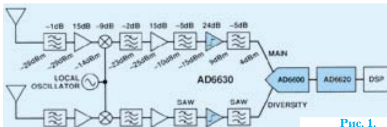
Рис. 1. Структурная схема приемного тракта GSM с усилителями AD6630
